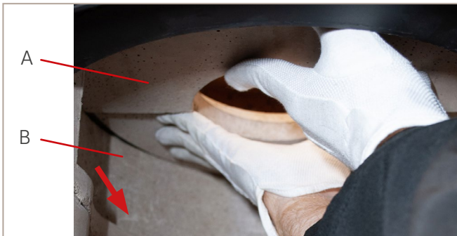
Abb. 16: Prallplattenhalter links entnehmen
