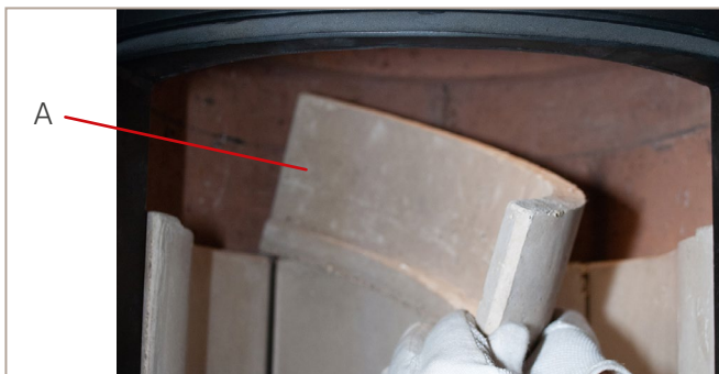
Abb. 20: Prallplattenhalter rechts ausbauen
